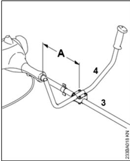
N Instale el manillar (4) en el tubo de mando (3) aprox. 15 cm (6 pulg) (A) delante de la caja del motor.
